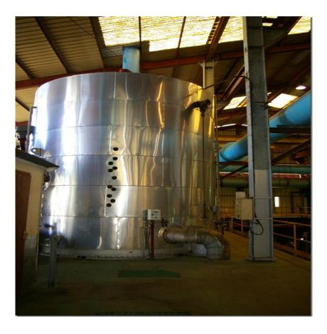
Les condensats du premier corps d'évaporation sont retournés en totalité à la centrale thermique. Ce procédé permet à la centrale thermique d'optimiser sa consommation d'eau. Les condensats des corps d'évaporation suivants servent à l'alimentation en eau du diffuseur ainsi qu'aux différentes étapes de la fabrication.
